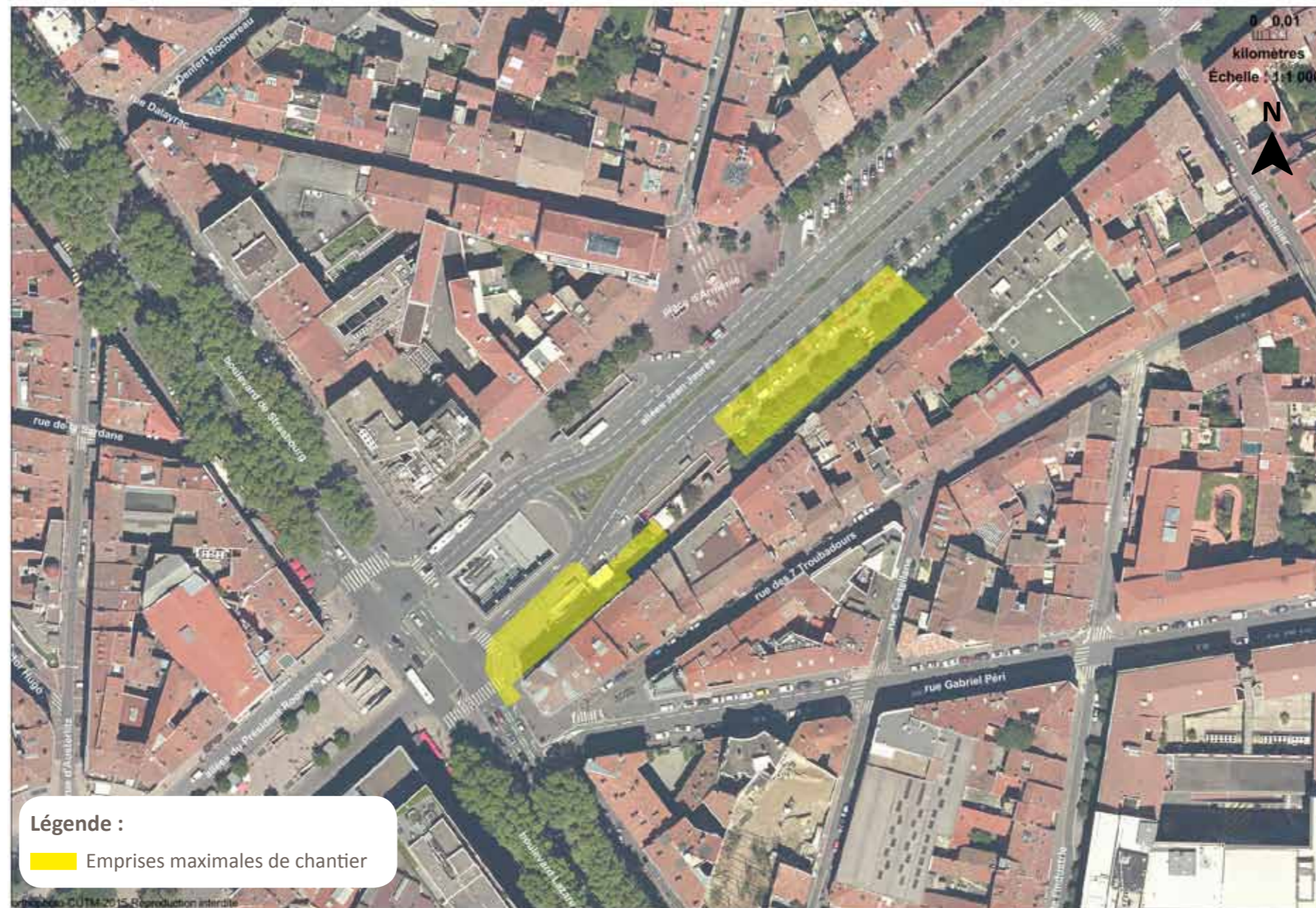
Emprises de chantier, pour les travaux d'amélioration des flux ligne B - ligne A, station Jean Jaurès (Source : EGIS, AVP, décembre 2015)
